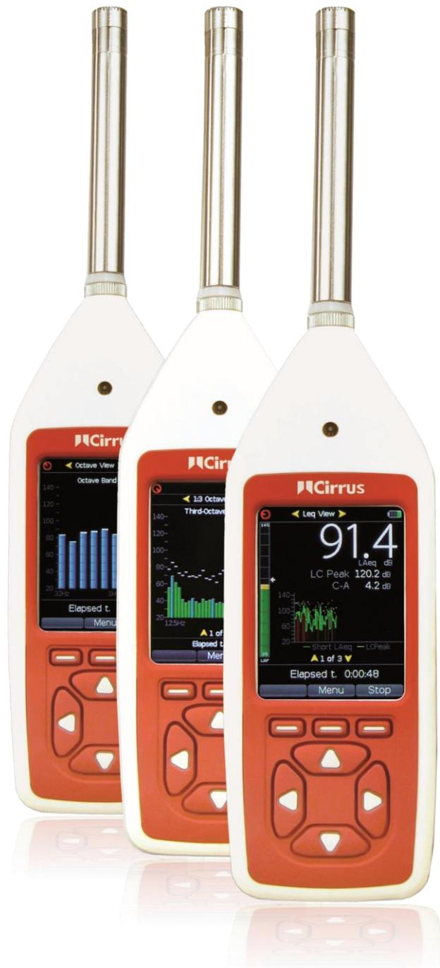
O valor de  $L_{Ceq}-L_{Aeq}$  (C-A) também é medido, o que pode ser usado para selecionar EPI usando o método HML.
